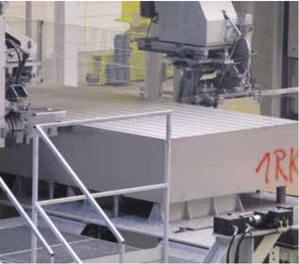
Rohbarren als Ausgangsmaterial
